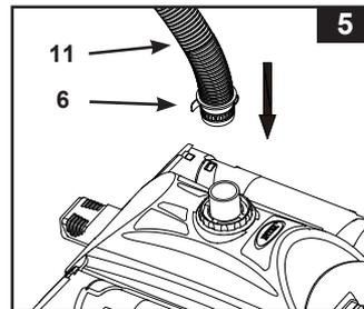
6. Coloque el limpiador dentro del agua. Llene la manguera con agua sumergiendo la manguera en el agua de esta manera quitará todo el aire que tienen las mangueras.
