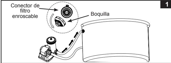
2. Atornille el final de la manguera A (8) con el adaptador al conector del colador con rosca, dentro de la piscina. Ver Fig. 2.
