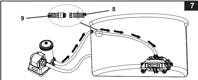
9. Encender la depuradora y asegurarse de que el agua está fluyendo por el aparato. El limpiador automático deberá empezar a moverse y aspirar el suelo. Ver Fig. 8.
