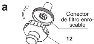
Enrosque el adaptador de manguera B (12) al conector de filtro enroscable desde el interior de la pared de piscina.
