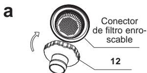
Enrosque el adaptador de manguera B (12) al conector de filtro enroscable desde el interior de la pared de piscina.
