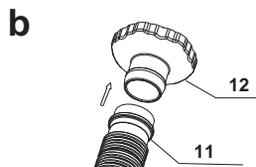
Conecte el otro extremo de la manguera (11) al adaptador de manguera B (12).
