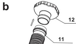
Conecte el otro extremo de la manguera (11) al adaptador de manguera B (12).
