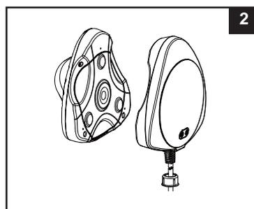
2. Coloque el transmisor (2) en la parte exterior de la pared de la piscina y coloque la luz (1) en la parte interna de la pared de la piscina sumergida bajo el agua. Verifique que los polos magnéticos del transmisor coinciden correctamente con los polos magnéticos del artefacto de luz. **Vea el dibujo (3).**
