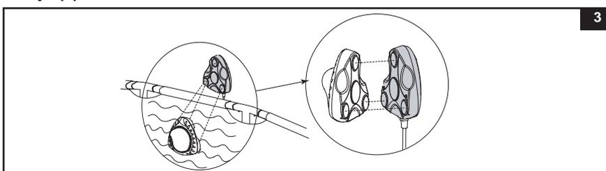
3. Ajuste la posición de la luz moviendo a mano el transmisor hacia arriba o abajo o hacia los costados.
