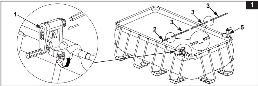
3. Enganche el extremo en "C" del gancho en forma de C (4) en el conjunto de tubos de aluminio. Asegúrese de que los ganchos en forma de C (4) estén repartidos uniformemente a lo largo del conjunto de tubos de aluminio. Sujete el extremo del gancho al borde del cobertor solar. Véase Figura 2.
