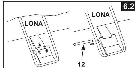
7. Tire de la parte de debajo de los soportes laterales hacia fuera en dirección contraria a la lona para que las correas queden tirantes. Repetir esto para todas las correas (vea el dibujo 7).
