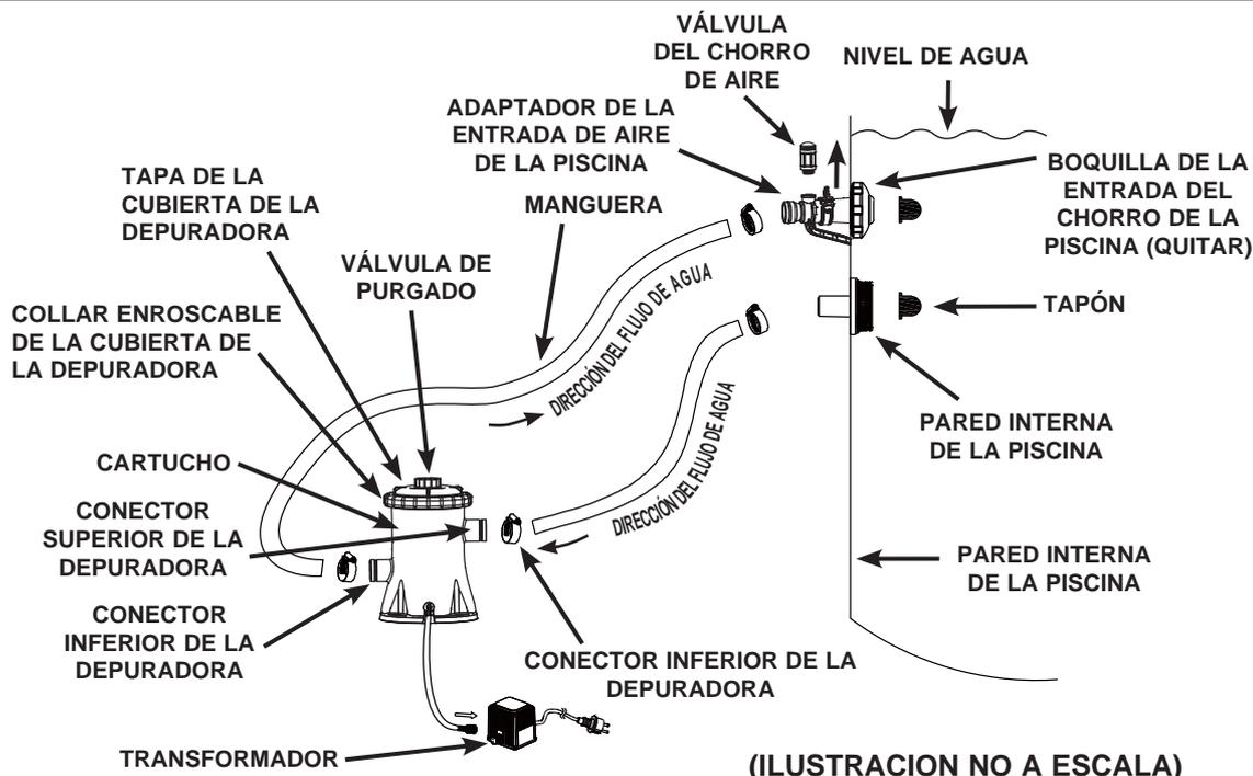
El cable de alimentación a la fuente de 220-240 voltios de energía eléctrica de la bomba debe estar colocada a de más de 3,5 m de distancia de las paredes de la piscina. Verifique con las autoridades locales para determinar las normativas adecuadas y los requisitos para la "instalación eléctrica de las piscinas y equipos en otros recipientes". La siguiente tabla es sólo para referencia:
