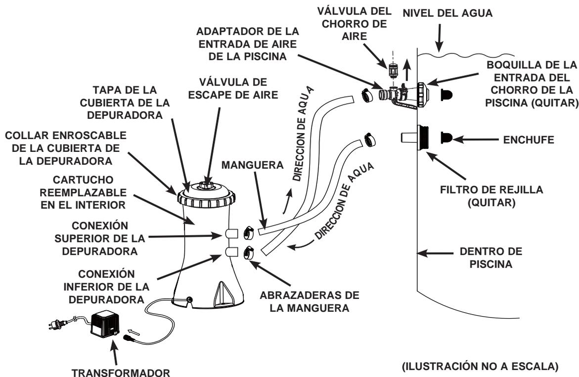
El cable de alimentación a la fuente de 220-240 voltios de energía eléctrica de la bomba debe estar colocada a de más de 3,5m de distancia de las paredes de la piscina. Verifique con las autoridades locales para determinar las normativas adecuadas y los requisitos para la "instalación eléctrica de las piscinas y equipos en otros recipientes". La siguiente tabla es sólo para referencia:
