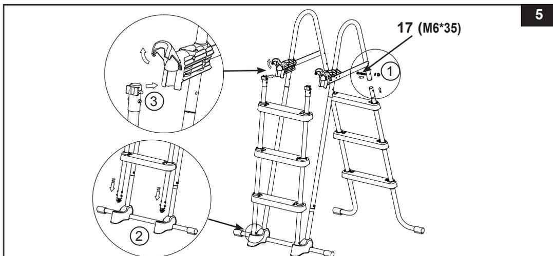
**IMPORTANTE:** No apriete totalmente los tornillos hasta que haya terminado el montaje.
